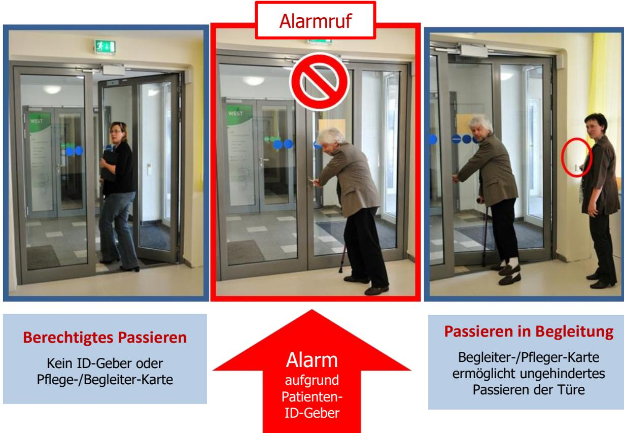
**Telegate** ist ein Eingangs-/Ausgangs-Überwachungssystem mit RFID-Technologie, welches speziell für den Einsatz in Gesundheits- und Pflegeeinrichtungen entwickelt wurde. Telegate GUARD 01 berücksichtigt und erfüllt langjährig gestellte Anforderungen zur Unterstützung der Pflegenden bei der Betreuung.
