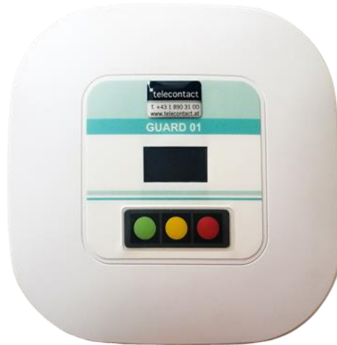
Telegate Guard 01 - Türwächter RFID-Lesegerät erkennt Arbandsender
